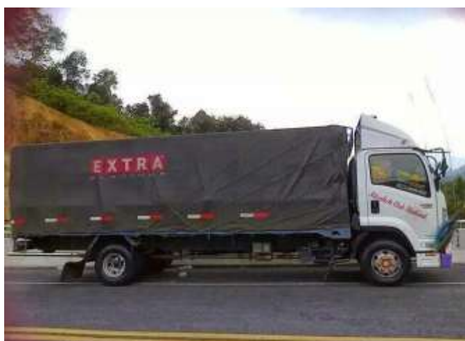
ภาพที่ 5.2.1-5 ตัวอย่างการปิดคลุมวัสดุก่อสร้างของรถบรรทุก
